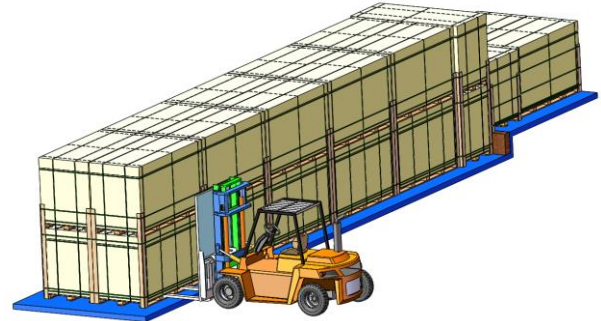
Rozładunek pakowania pionowego krótszym bokiem i pakowania "U" za pomocą wózka widłowego
